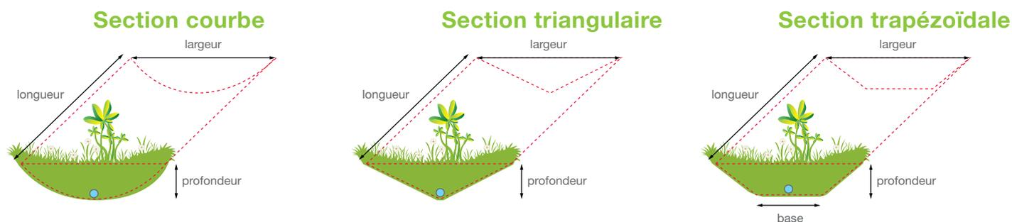
Pour les sections courbes :  $V = \text{longueur} * \text{Largeur} * h * (3,14 / 4)$
