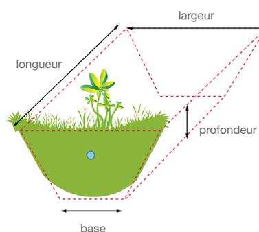
Pour les sections triangulaires :  $V = \text{longueur} * (\text{largeur} / 2) * \text{profondeur}$
