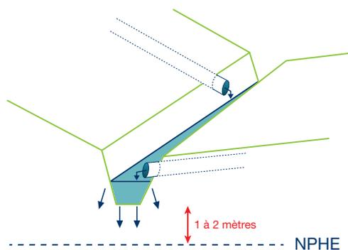
**NPHE** : niveau des plus hautes eaux de la nappe (prévoir idéalement 2 mètres de hauteur en zone d'alimentation de captage).
