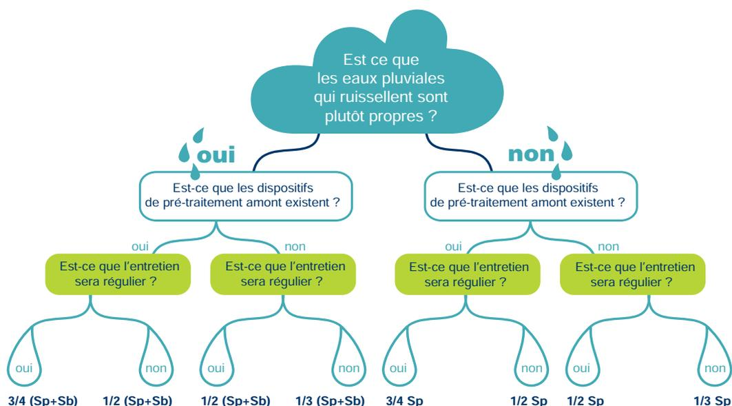
La surface «  $Sp$  » correspond à la surface des parois concernée par l'infiltration, et «  $Sb$  » à la surface de la base. Les dimensions de la tranchée (longueur, largeur et profondeur) sont choisies au départ par rapport aux contraintes du site, et seront modifiées si nécessaire à la fin du calcul.
