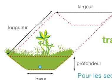
Pour les sections trapézoïdales :
